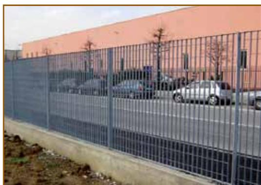
Recinzione modulare costituita da pannelli in grigliato realizzati attraverso l'unione per elettrofusione di barre portanti verticali e tondi trasversali. La piantana standard per il montaggio è in ferro piatto da 60 x 7 mm.
